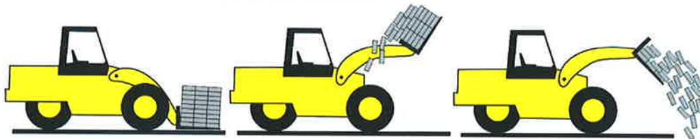
Risque de chute de la charge suite à une manœuvre non intentionnelle du machiniste.
