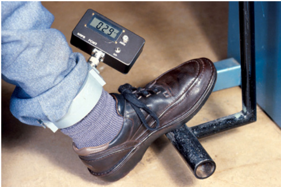
Illustration C.7 — Pince à courant utilisée pour mesurer le courant dans les membres pendant l'utilisation d'un poste de soudage diélectrique de 27 MHz
