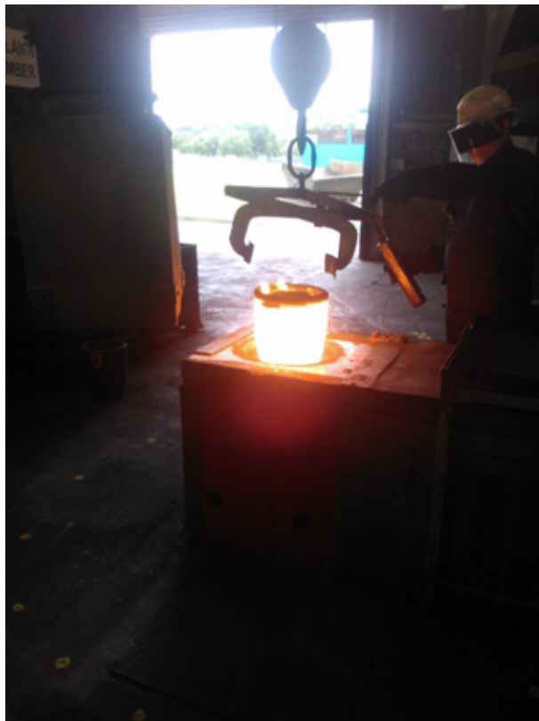
Illustration 8.5 — Les tâches supposant de s’approcher du four ont été effectuées lorsque le four était hors tension
