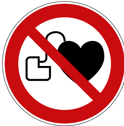
Illustration 4.12 — Exemples d’avis d’avertissement relatifs à la présence de champs magnétiques puissants et illustration du symbole d’interdiction à l’attention des porteurs de DMIA
