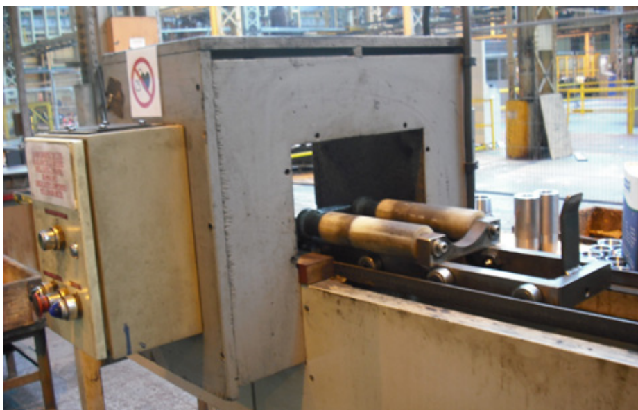
Illustration 5.2 — Démagnétiseur avec chariot coulissant
