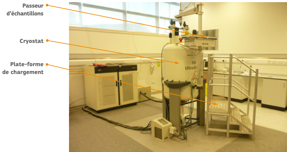
Illustration 2.1 — Appareil de RMN, équipé d'un passeur d'échantillons et d'une plate-forme de chargement
