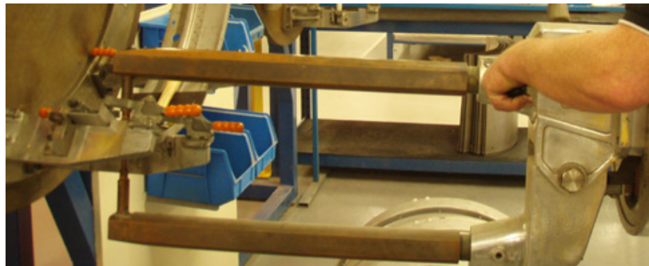
Illustration 7.2 — Poste de soudage par points mobile suspendu
