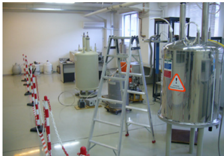
Illustration 2.4 — Délimitation de la zone interdite par un grillage de protection et un marquage au sol
