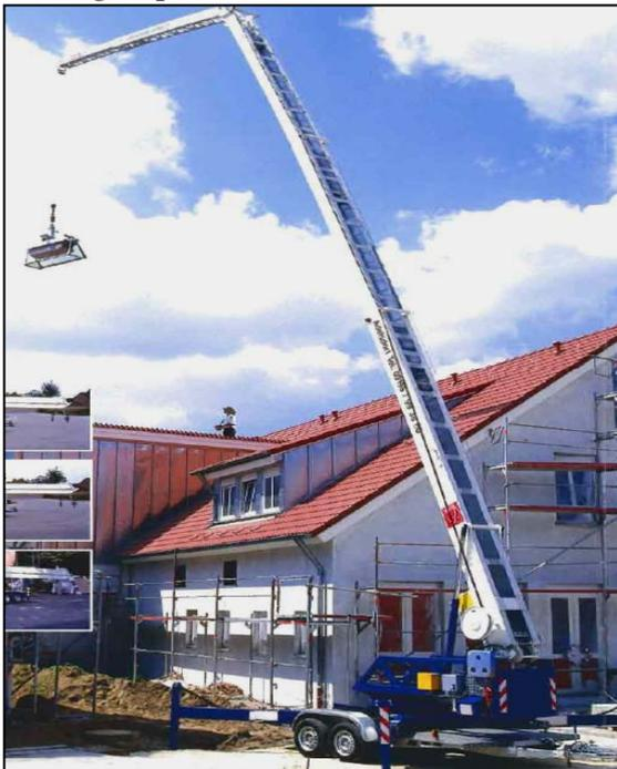
**Figure 2 :** Exemple d'une grue de chantier à montage rapide
