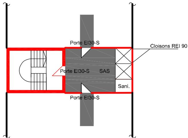
**Figure 21** Ascenseur avec palier faisant fonction de sas.
