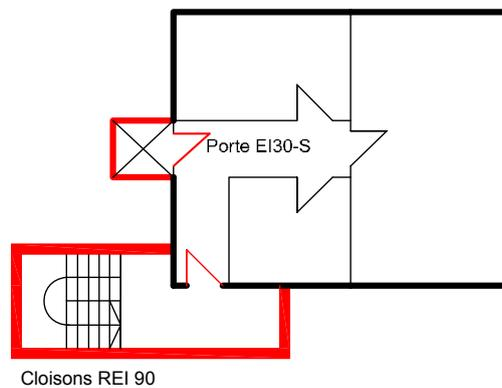
**Figure 22** Ascenseur aboutissant directement dans une unité d'exploitation
